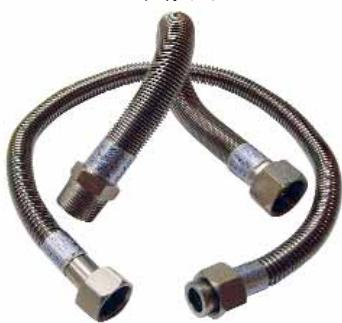
Основанная в 2000 году турецкая компания Kuzufleks Metal Hortum осуществляет полный цикл производства газовых сильфонов бытового назначения: с помощью лазерной сварки изготавливается шланг из листовой нержавеющей стали, затем методом механического формования делает сильфон и аргонно-дуговой сваркой приваривает к нему концевые фитинги, обеспечивая надежное соединение. Более 80% изделий уходит на экспорт.
